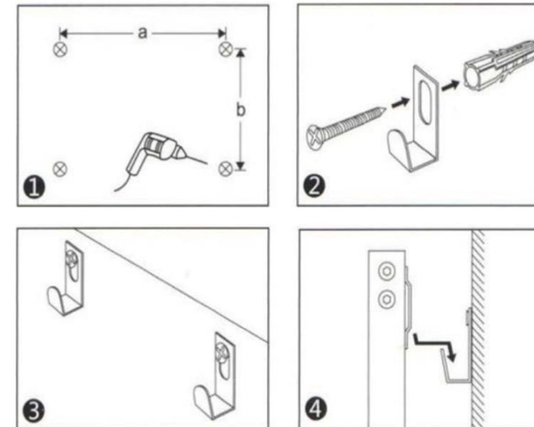
1. Percez les quatre trous dans le mur à l'aide des supports à l'arrière et insérez les chevilles fournies dans les trous pour qu'elles soient congruentes avec le mur.
