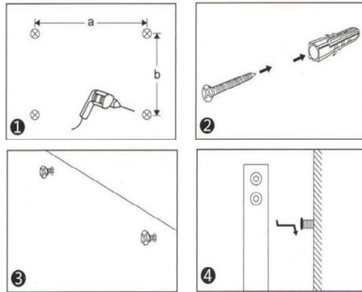
1. Percez quatre trous dans le mur, correspondant aux dispositifs de fixation à l'arrière, puis insérez les chevilles fournies dans les trous afin qu'elles affleurent à la surface du mur.
