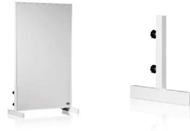
Placez les pieds de support autoportants sur le sol. Insérez les résistances dans la rainure prévue à cet effet. Ensuite, serrez le radiateur avec les vis fournies. Ces pieds de support conviennent uniquement aux panneaux de chauffage par infrarouge de la série P-E-DL de Königshaus.
